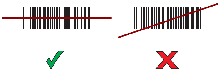
Figura 40 Patrón de enfoque del lector láser
